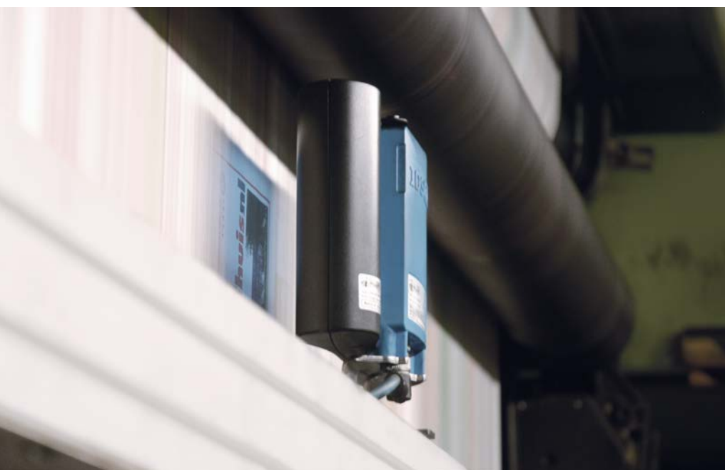
阿姆斯特丹TMG公司的罗兰Teleman印刷机上正在运行的IDS-3D色彩控制系统
