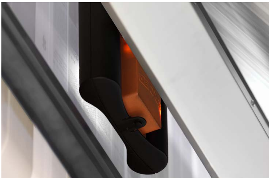
亚琛多夫印刷公司购买的QIPC产品，带有自动墨雾屏蔽的mRC-3D摄像头
